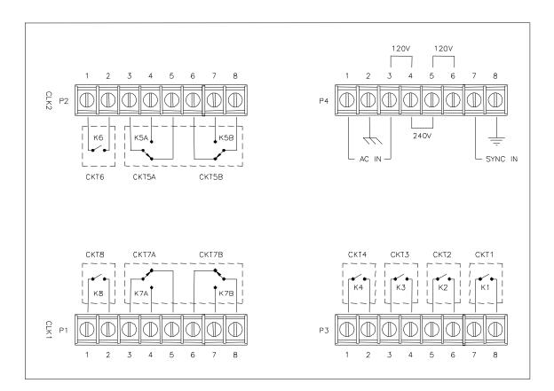
Fig. D8 - POWER SUPPLY TERMINAL BLOCKS
